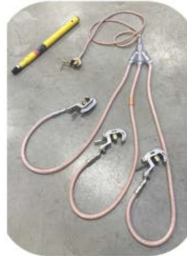
So sieht die Ausrüstung aus, die diesem Schritt gewidmet ist. Um den Erdungsstern zu installieren, muss zuerst der Erdungskontakt und dann die aktiven Stromkreiskontakte verlegt werden.
