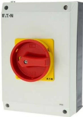
L'interrupteur de sécurité a un rôle de séparation. Il permet d'effectuer la coupure forcée de l'alimentation électrique en cas de risque ou d'intervention. La séparation assure la mise hors tension de tout ou d'une seule partie d'une installation.
