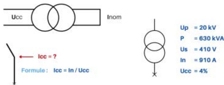
Oben ist ein Schema zur Veranschaulichung des Kurzschlussstroms abgebildet. Um den Kurzschlussstrom an einem Transformator zu messen, muss die angegebene Formel angewendet werden, d. h. den Nennstrom des Transformators, der durch die Kurzschlussspannung des Transformators geteilt wird.
