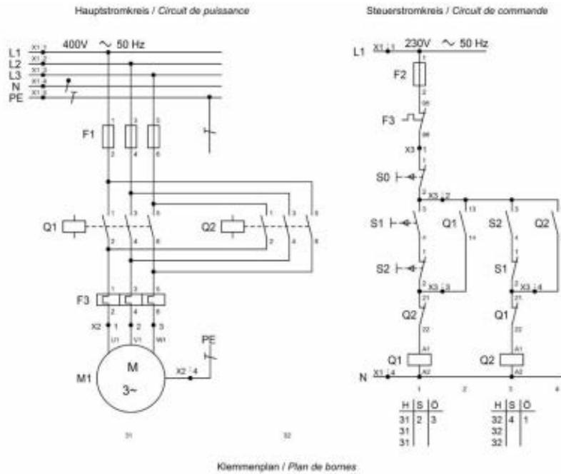
Es ist wichtig, den Schaltplan des Geräts, an dem man arbeitet, zu konsultieren: Anhand dieses Schaltplans, der einen Stromkreis mit indirekter Umkehrung der Drehrichtung eines Motors zeigt, kann man erkennen, wo man die Stromversorgung unterbrechen muss. Die Geräte sollten auf Plänen und vor Ort markiert werden, um Verwechslungen zu vermeiden.
