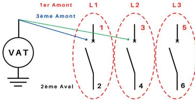
On peut effectuer les mesures selon la méthode des 3A : d'abord en amont, puis en aval, et de nouveau en amont du sectionneur.
