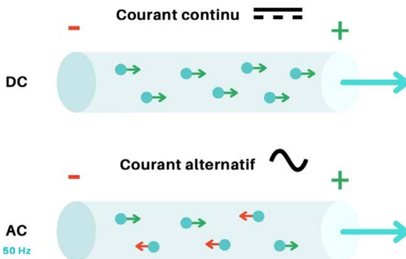
Le courant électrique est produit par le déplacement d'électrons dans un milieu conducteur, sous l'impulsion d'une tension électrique. Cette tension, selon qu'elle est continue ou alternative, peut générer deux types de courants :
