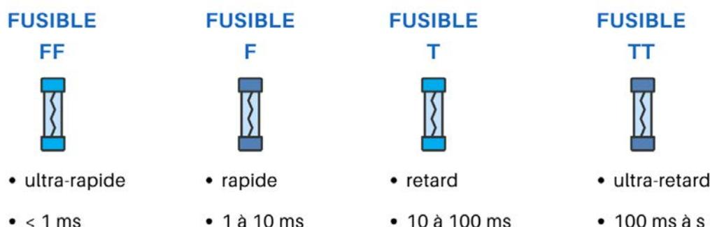
Le standard CEI 60127 prévoit 4 types de fusibles, chacun étant défini suivant le temps nécessaire pour couper dix fois le courant nominal : le fusible FF, ultra- rapide, inférieur à 1 ms, le fusible F, rapide, de 1 à 10 ms, le fusible T, retard, de 10 à 100 ms, et le fusible TT, ultra-retard, de 100 ms à 1s. Pour des besoins de coupure plus élevés, il existe également le type HPC : Haut Pouvoir de Coupure, allant jusque 100 kA.
