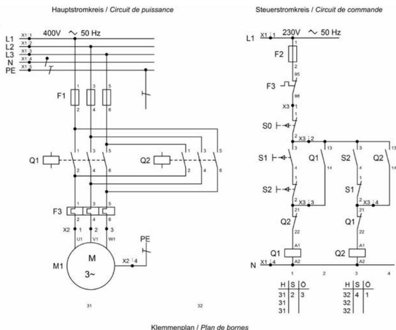
Il est important de consulter le schéma électrique de l'appareil sur lequel on intervient : celui-ci, qui présente un circuit à inversion indirecte du sens de rotation d'un moteur, permet de voir où couper l'alimentation. Les équipements doivent être repérés sur des plans et sur le site afin d'éviter les confusions.
