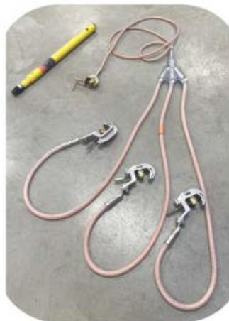
Une mise à la terre n'est pas forcément nécessaire, mais en basse tension elle est à effectuer en cas de présence de batteries de condensateurs, d'un risque de tension induite, de câbles de grande longueur ou de générateur comme un onduleur ou un groupe électrogène.
