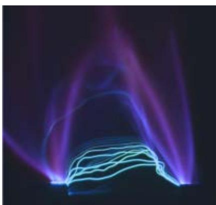
Un court-circuit peut provoquer un arc électrique. En cas de création d'un arc électrique, celui-ci provoque différents effets :
