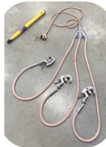
So sieht die Ausrüstung aus, die diesem Schritt gewidmet ist. Um den Erdungsstern zu installieren, muss zuerst der Erdungskontakt und dann die aktiven Stromkreiskontakte verlegt werden.
